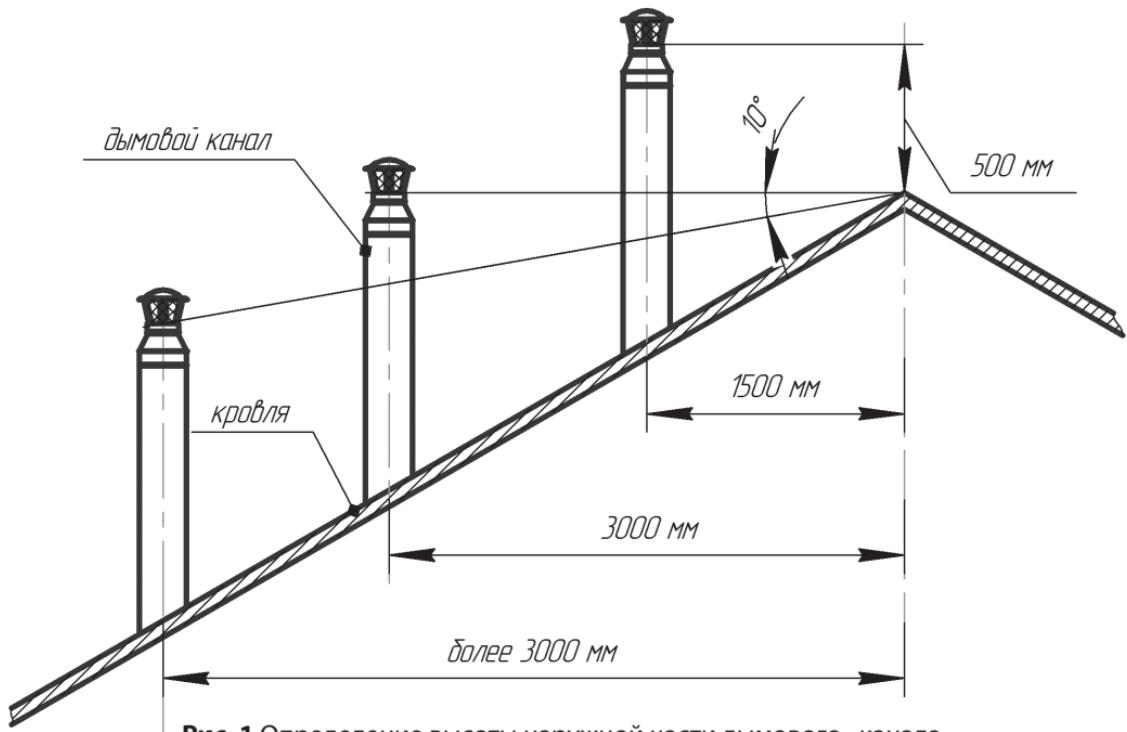
**Рис. 1** Определение высоты наружной части дымового канала.
